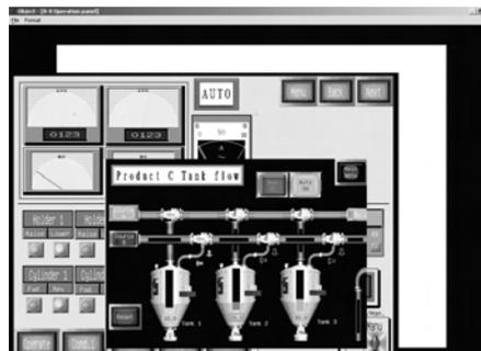
De forma parecida al GX Simulator, cualquier cambio o modificación realizada en el diseño de la pantalla GOT con el GT Designer3 puede ser comprobado y depurado empleando el GT Simulator.
