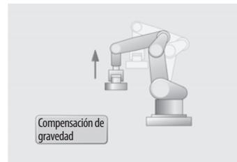
Compensación de gravedad para una mayor precisión de posicionamiento y paletizado
