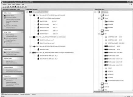
Puede emplearse para configurar el módulo maestro Profibus DP y todos los módulos esclavos, incluyendo variadores y HMIs, de Mitsubishi, así como con productos de otros fabricantes.
